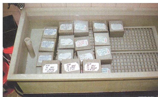
Lagerung der Betonproben unter Wasser
