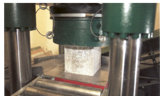
Prüfung der Druckfestigkeit an einem Würfel
